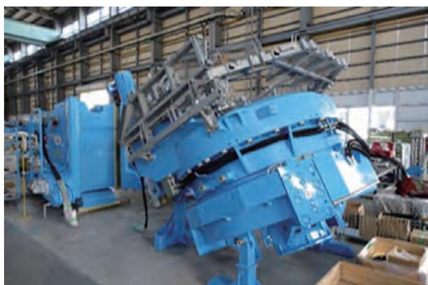
▲ 製造中の鋼管杭用サイレントパイラー
