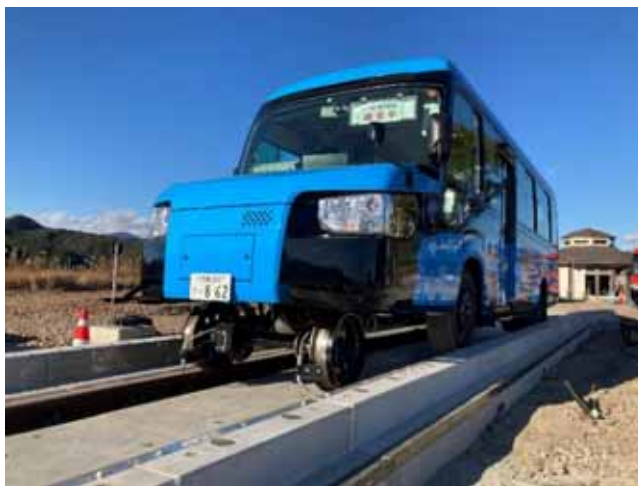
写真 3-2 世界初の営業運転を行っている DMV
